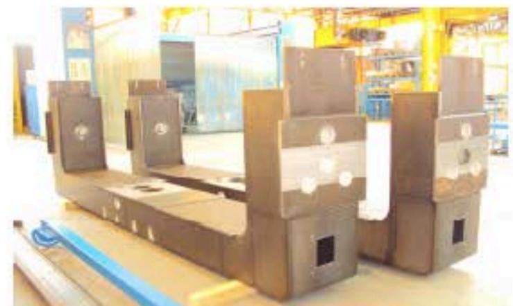
Châssis mécano-soudés, usinés (S355)
